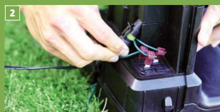
2. Pripojte ohraničujúci kábel k nabíjacej stanici
